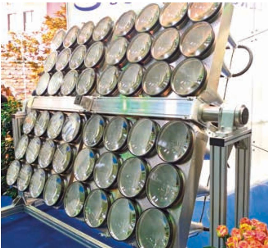
**FIGURA 6 – Componente fondamentale di un sistema fotovoltaico a concentrazione è il grande sistema di specchi che ha lo scopo di concentrare la luce proveniente dal sole sul ricevitore fotovoltaico posto nel fuoco ottico del sistema**
