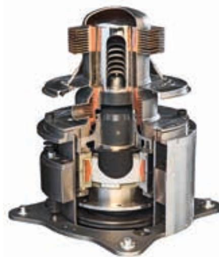
SCHEMA MOTORE STIRLING. Una particolarità di questo motore è quella di funzionare senza fare ricorso a valvole. Le sole parti in movimento sono il pistone ed il dislocatore che agiscono collegati su una camma a 90 gradi
