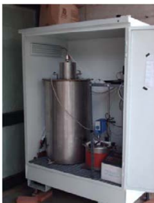
Fig. 2 Digestore anaerobico da laboratorio e sistema di accumulo del biogas
