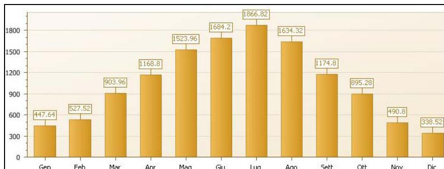
Figura 6 – Energia mediamente prodotta dall'impianto nei vari mesi dell'anno
