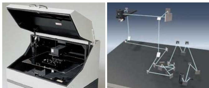
Figura 4 – Spettrofotometro SolidSpec-3700: comparto porta campioni e vista del percorso ottico
