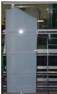
Figura 10: Fase di realizzazione del vetrocamera con aerogel in intercapedine
