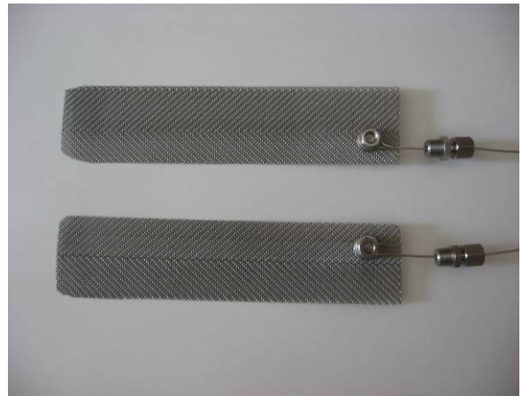
Figura 1: Elettrodi utilizzati nella cella fotoelettrolitica
