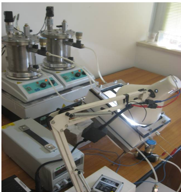
Figura 8: Apparatto sperimentale durante una prova di fotoelettrolisi
