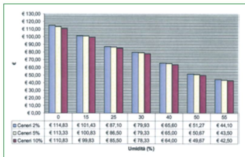
FIGURA 2 - Andamento del prezzo della biomassa al variare del contenuto di umidità e di ceneri (PCI = 17.000 kJ/kg) Fonte: CRB
