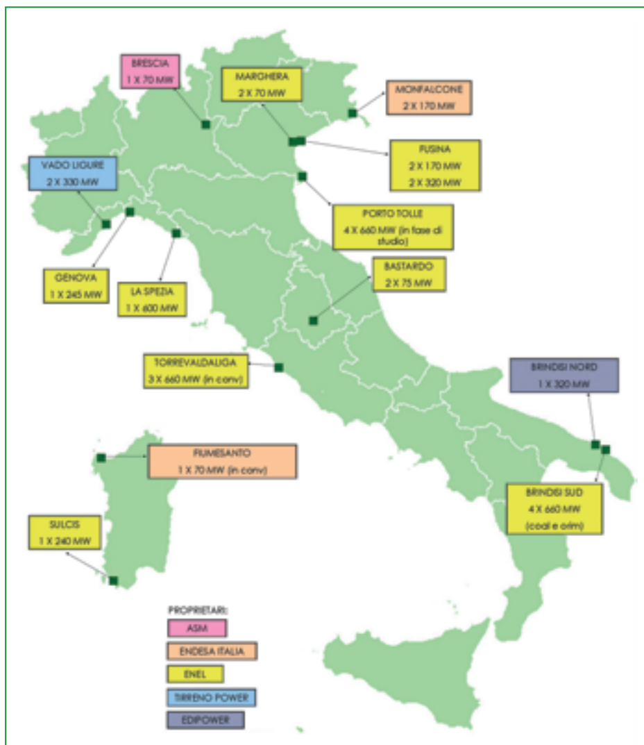
Figura 1 - Centrali a carbone in fase di riconversione alla co-combustione e relativi gestori
