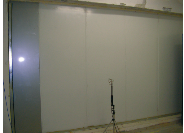
Figura 2: Parete in lamiera, vista durante le operazioni di misura
