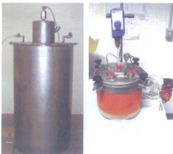
Digestore e gasometro da laboratorio
