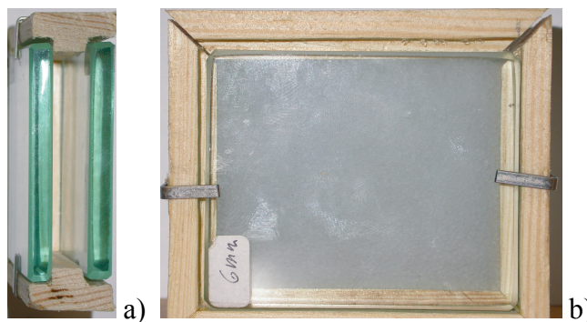
Figura 2: Portacampione assemblato con solo il vetro, vista dall'alto (a); campione pronto per la prova, vista frontale (b)
