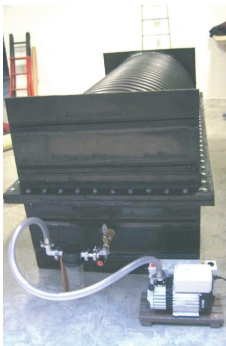
Figura 14: pompa applicata per la prova di vuoto
