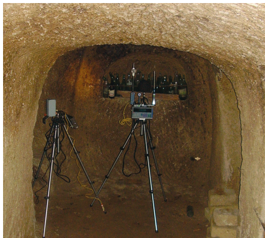
Figura 3: centraline microclimatiche posizionate al termine del corridoio, sul lato nord, della cavità in corrispondenza delle nicchie D e E.
