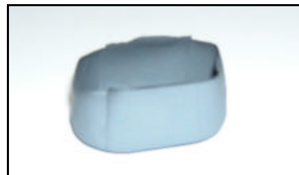
Fig. 4: Contenitore in SiC dopo il processo di sinterizzazione.
