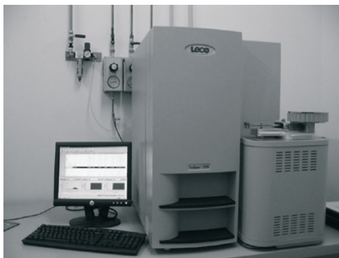
Figura 3: Truspec CHN LECO per l'Analisi Ultima
