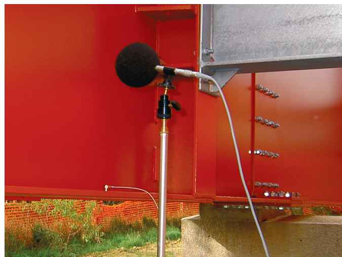
Fig. 6 – Posizionamento dell'accelerometro e del microfono
