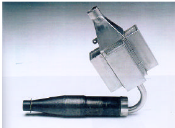
Fig.4 - fotografia della marmitta elettronica collegata al condotto di scarico del go-kart
