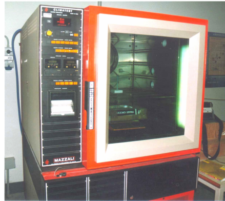
Fig. 7.1: Camera climatica impiegata per l'invecchiamento dei campioni di vetro
