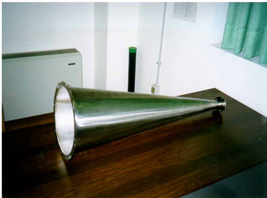
Fig. 13: fotografia dell'adattore di impedenza.
