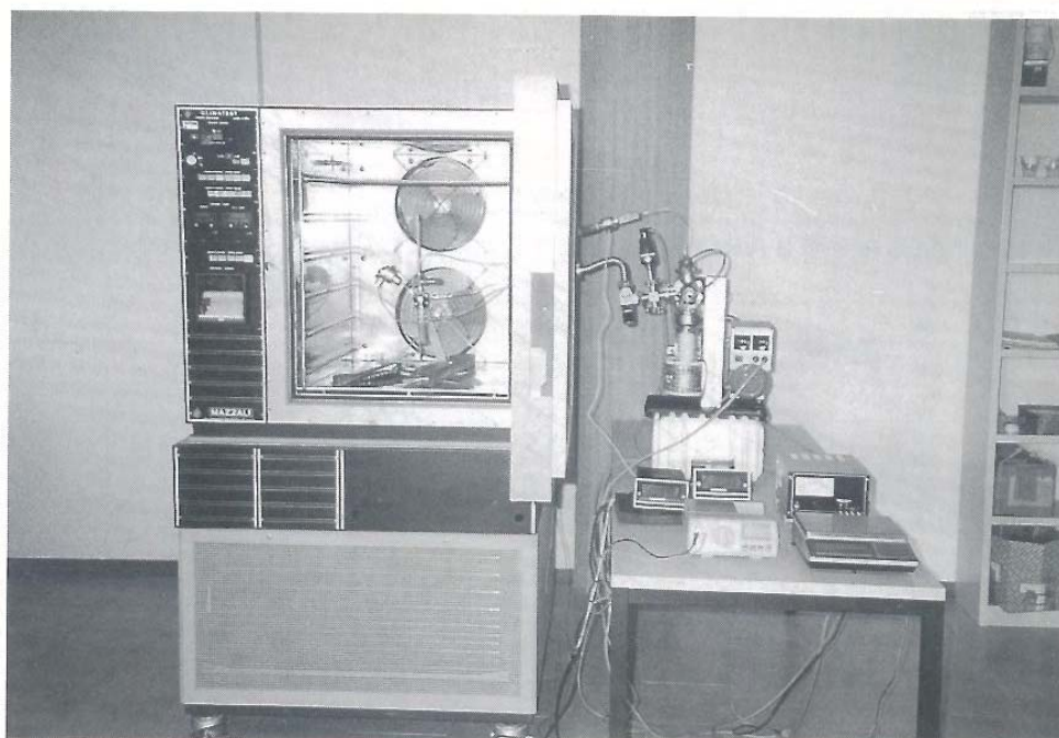
Fig. 1 - Veduta d'insieme dell'apparecchiatura per le misure di tensione di vapore.
